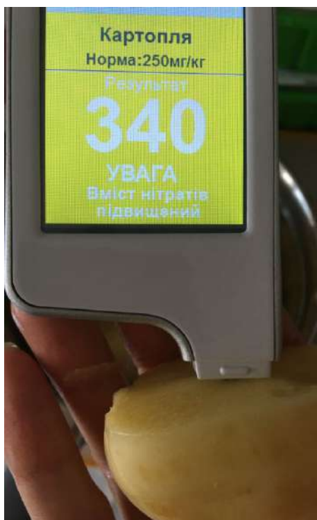
Рис. 1. Виявлення за допомогою нітратоміра Anmez Greentest підвищеного вмісту нітрат-іонів у досліджуваному зразку картоплі
