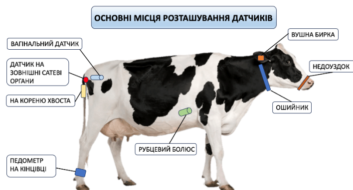
Рис. 1. Основні місця розташування блоків датчиків на тілі тварини
