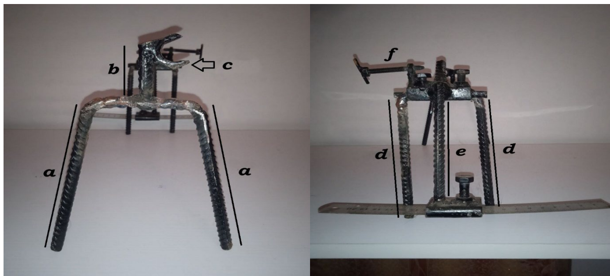
Рис. 1. Загальний вигляд приладу Хофмір, запропонованого для вимірювання кутів копитець у корів Позначення: а, d – ніжки (14 см.); b – підставка до тримача селфі-палки (5 см.); c – тримач селфі-палки; e – тримач лінійки; f – гвинтовий фіксатор селфі-палки
