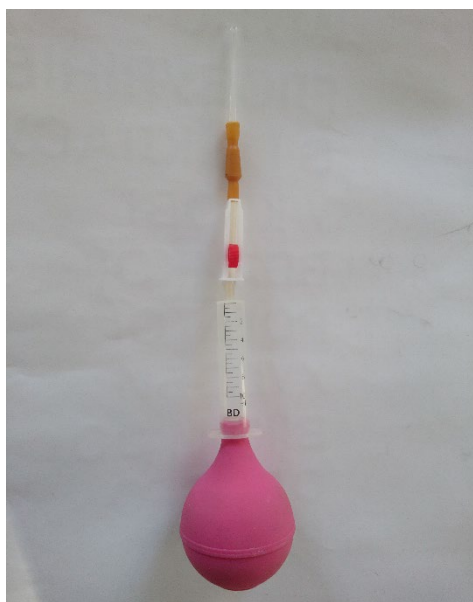
Рис. 2. Прилад для відбирання надосадової рідини із пробірок і ресуспендування осаду
